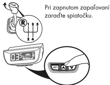
Tlačidlami „^“ alebo „v“ nastavíte hlasitosť zvukovej signalizácie. Pokiaľ je vzdialenosť od prekážky menšia ako 0,3m, zvuková signalizácia sa automaticky nastaví na maximálnu hlasitosť. Od výroby je nastavená maximálna hlasitosť.
