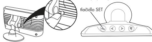
Pri zapnutom zapaľovaní zaraďte spiatocku. Stlačte tlačidlo SET na dve sekundy, uvoľnite a po jednej sekunde ho opäť stlačte pre zapnutie/vypnutie hlasovej signalizácie.
