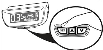
Pri zapnutom zapalovaní zaradíte spiatku. Stlačte jedenkrát tlačidlo SET pre zapnutie/vypnutie hlasovej signalizácie.
