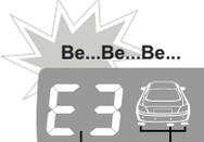
Systém detekoval vadný snímač. Bzučiak pípne 3x a na displeji sa zobrazí číslo vadného snímača. Ostatné snímače fungujú normálne.
