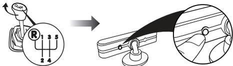
Tlačidlom SET nastavíte hlasitosť zvukovej signalizácie. Pokiaľ je vzdialenosť od prekážky menšia ako 0,3m, zvuková signalizácia sa automaticky nastaví na maximálnu hlasitosť. Od výroby je nastavená maximálna hlasitosť.
