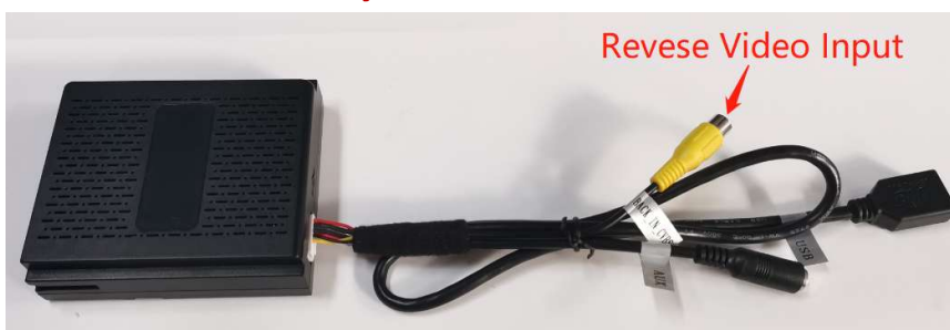
Kabeláž adaptéru se vstupem označeným „Reverse Video Input“.
