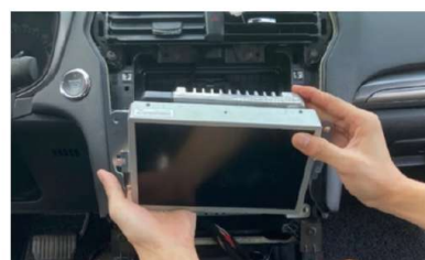
Postupné uvolnění konzole, dekoračního rámečku a vyjmutí displeje.
