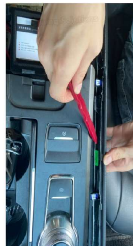
Vlevo příklad originálního rozhraní Ford SYNC 2; vpravo začátek demontáže středového panelu.
