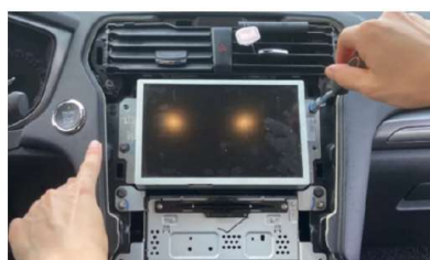
Postupné uvolnění konzole, dekoračního rámečku a vyjmutí displeje.
