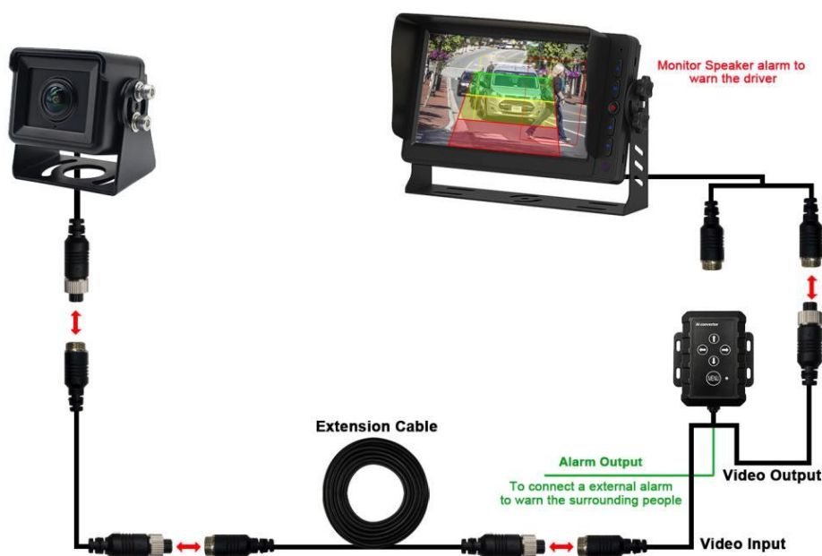
Příklad propojení kamery, prodlužovacího kabelu, AI převodníku a monitoru.
