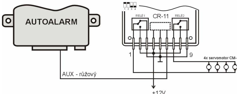
Pro ovládání servomotorů přepněte modul CR-11A do režimu číslo 4 a v autoalarmu nastavte délku impulsů pro centrální zamykání 0.3s. Jiná délka impulsů při tomto zapojení poškodí servomotory CM-2!!!
