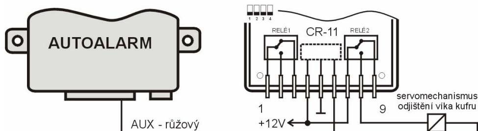
Pro tuto aplikaci přepněte modul CR-11A do režimu číslo 1 a v nastavení autoalarmu zablokuje Panic poplach (pokud ho podporuje). Víko kufru tak bude možné odjistit současným stiskem obou tlačítek ovladače (při odjištěním autoalarmu).
