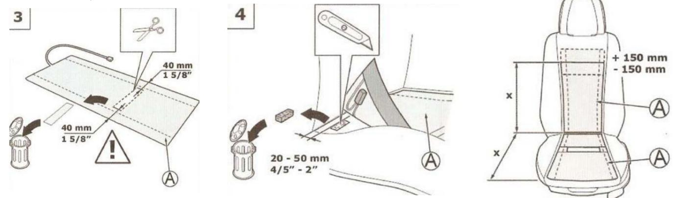
Podľa naznačeného miesta urobte otvor do vyhrievacieho telesa. Na sedadle urobte vyrezaním priestor na termostat vyhrievacieho telesa, aby potom nevyčnieval a neprekážal obsluhu pri sedení. Dĺžku vyhrievacích telies prispôbte podľa obrázka.
