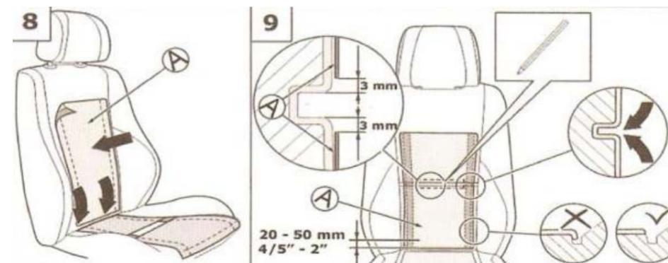
Podľa naznačeného miesta urobte otvor do vyhrievacieho telesa. Na operadlovej časti urobte vyrezaním priestor na termostat vyhrievacieho telesa, aby potom nevyčnieval a neprekážal obsluhu pri sedení. Dĺžku vyhrievacích telies prispôbte podľa obrázka.
