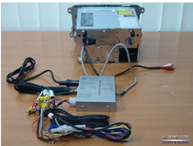
Připojte RGB adaptér podle obrázku
