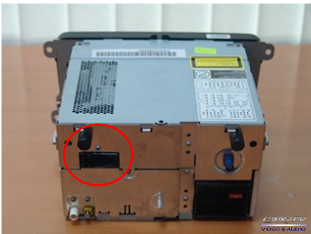
Zapojte RGB kabel do základní jednotky v označené pozici
