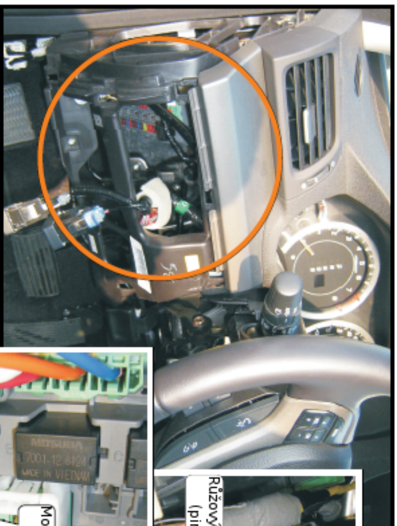
Zelený konektor 16 pinů za pojistkami
